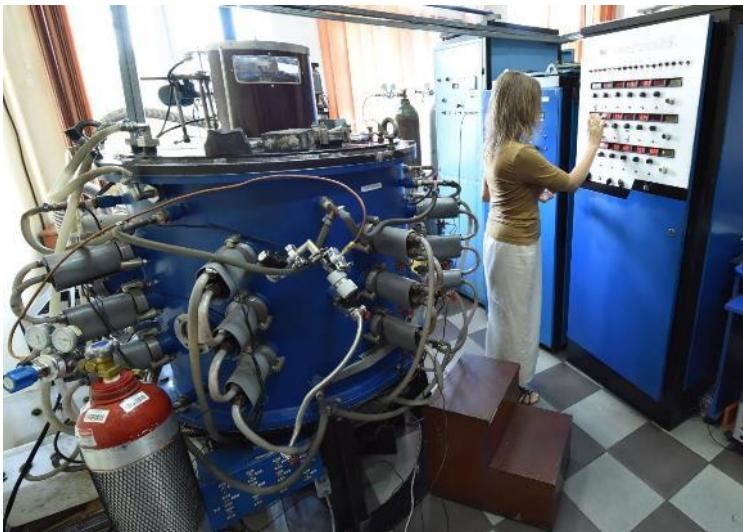
10. Instalatie TVA de depuneri de acoperiri cu Beriliu pe reactor de fuziune
