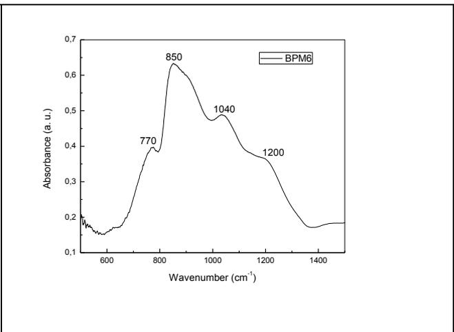
Fig. 2b). Curba de absorbție FTIR pentru proba BPM6
